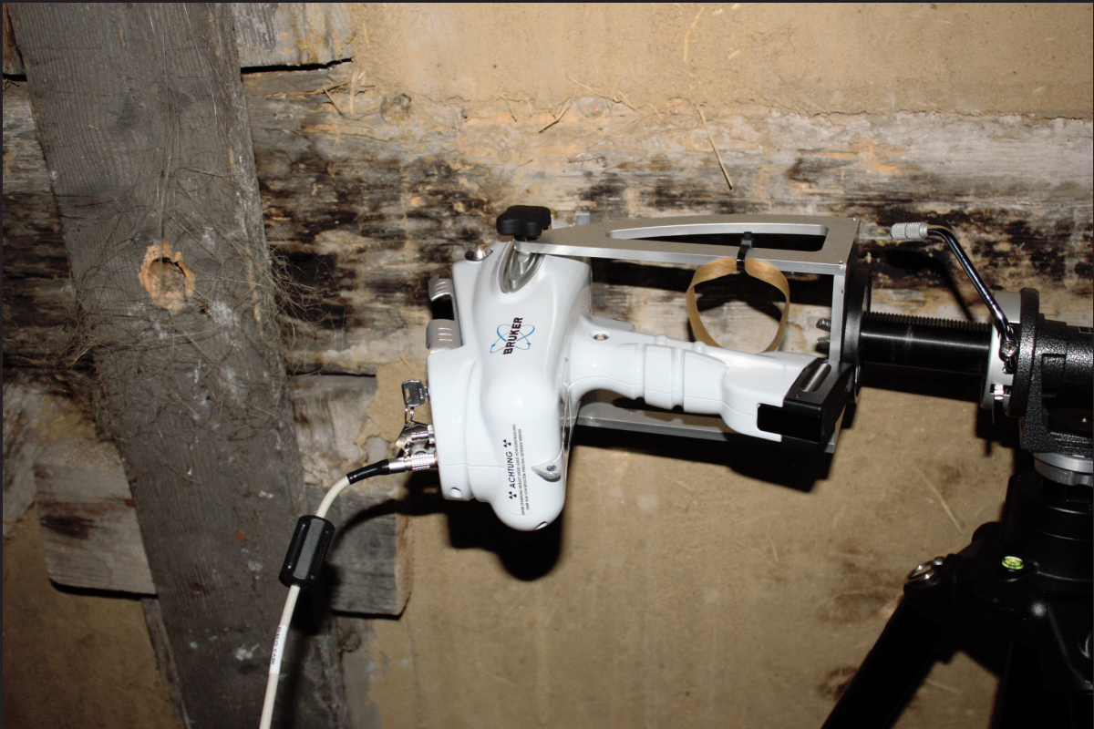
2: Untersuchung eines Holzbalkens unterhalb von Fenster SVII mit dem Handheld-Spektrometer Tracer III-SD Badania rygla poniżej okna SVII z „Handheld-Spektrometer Tracer III-SD”
